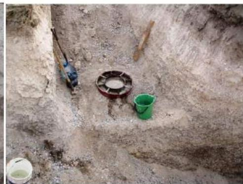
Imagen 5. Ensayo de infiltración, EI-4
