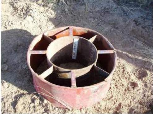
Imagen 1. Instalación de infiltrómetro, EI-1
