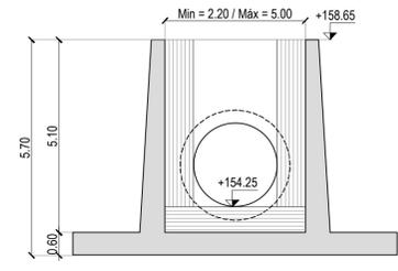
Obra de Disipación - Corte C-C
