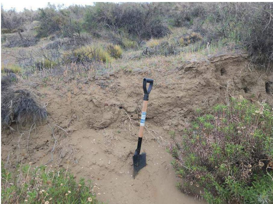
**Imagen N°24:** Vista en sentido S donde se observa el suelo arenoso con un desarrollo mayor a 100cm en inmediaciones a C2, sobre un corte del terreno en donde se ve claramente que todo este material es de sedimentos eólicos finos poco consolidados. Coordenadas: 45°55'58.23"S/ 67°35'58.95"O
