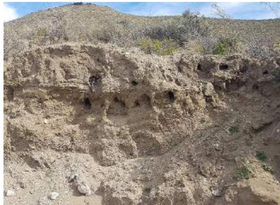
**Imagen N°35:** *Piping* y bioturbaciones en los suelos del proyecto “La Colina”. Generalmente las dimensiones de los *piping* son de aproximadamente 25 cm de alto, por 20 cm de ancho y de las bioturbaciones tienen un diámetro medio de 12 cm.
