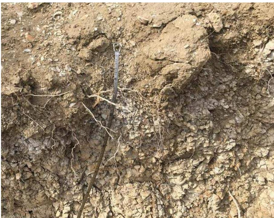
**Imagen N°26:** Vista de perfil de suelo con 25cm de desarrollo con Capa Fértil con raíces finas donde se observa el claramente el contacto con la Formación Patagonia y se puede ver como las arcilitas están altamente fracturadas en varias direcciones. Coordenadas: 45°55'50.10"S- 67°36'19.48"O
