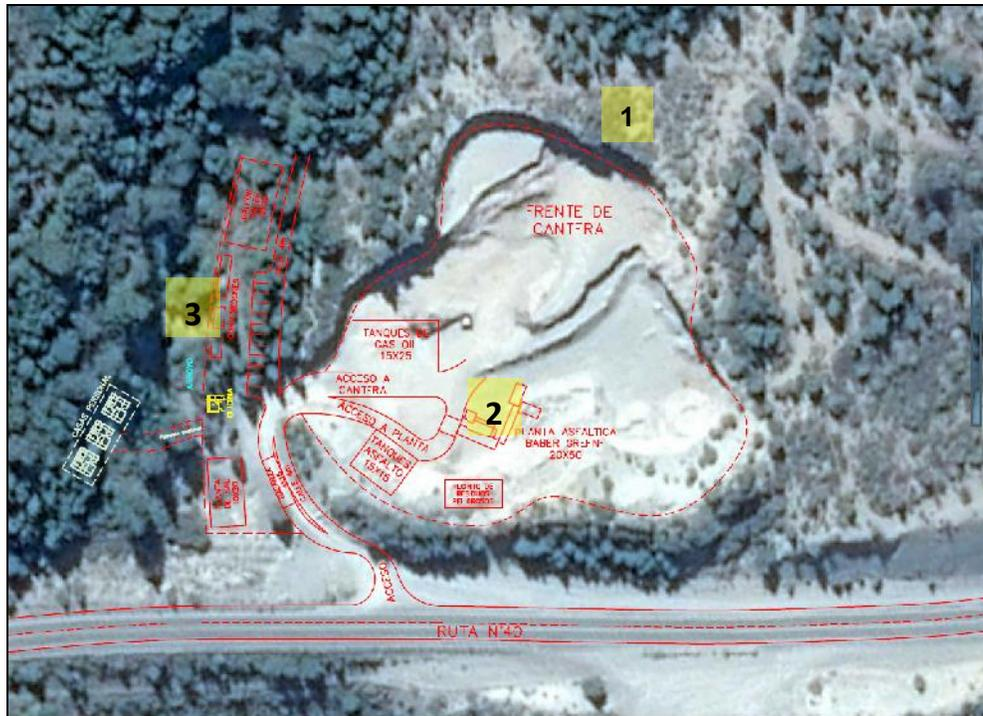
Se estima que el volumen explotable que resta de extraer de dicha cantera es aproximadamente de 25.000 m<sup>3</sup>. El volumen de cubierta de suelo vegetal se estima en unos 1.260 m<sup>3</sup> (espesor del suelo vegetal estimado 0,7 m), que será utilizada en la etapa de cierre y remediación de la cantera.
