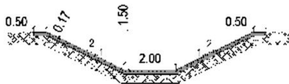
Ilustración 2: Geometría del canal Proyectado zona Golf Santa Lucía.
