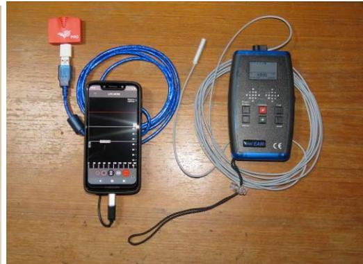
Fotografía 14 y 15. Equipos de ultrasonido detectores de murciélagos utilizados en la estación de escucha y en la búsqueda activa de actividad de quirópteros.
