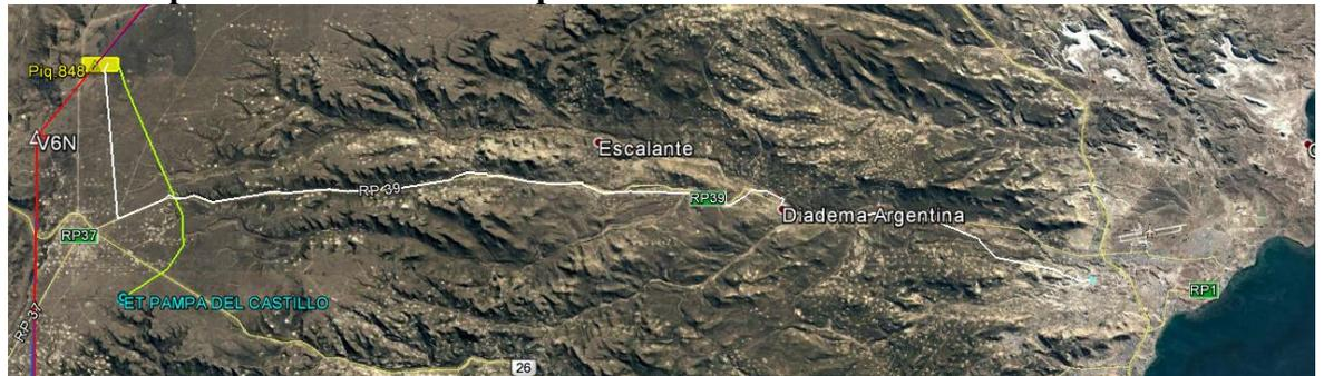
**A nivel referencial se agrega en las imágenes la Traza actual de la LAT 132 kV entre E.T Pampa del Castillo y E.T. Aeropuerto (Km. 5)**
