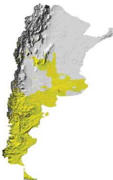
Figura 17. Factor de Capacidad >35% a 70m de altura.
