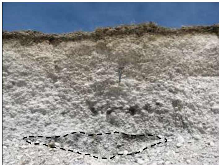
Fotografía 9. Gravas redondeadas fuertemente consolidadas por la presencia de cemento carbonático que actúa como ligazón entre los clastos. En forma ocasional se observa la presencia, en forma intercalada, de lentes de arenas gravosas (marcada en la imagen con una línea de contorno punteado).
