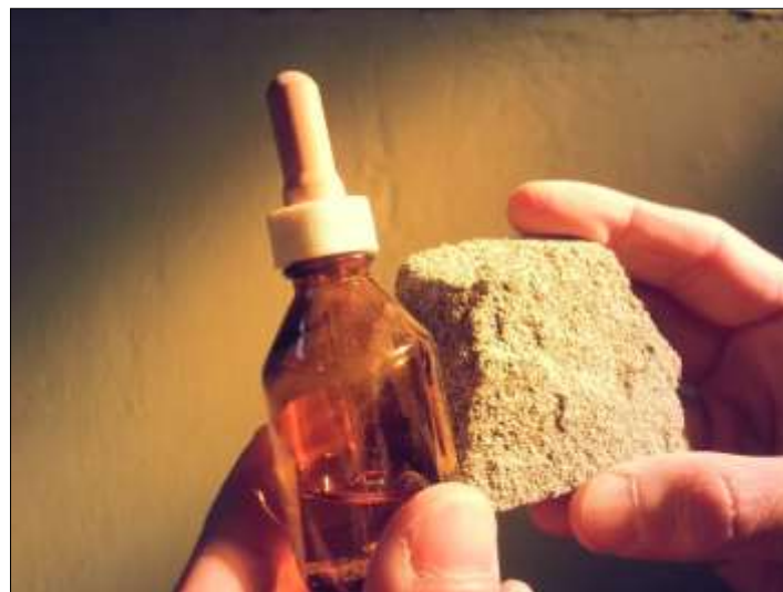
Fotografía 7. Fragmento de arenisca de grano grueso perteneciente a la Fm. Santa Cruz. Como características petrofísicas a destacar, se pueden mencionar: ausencia de cemento (lo que le confiere una condición de sedimentita muy friable que permite una fácil desagregación de los granos) y una buena porosidad del material en su conjunto.
