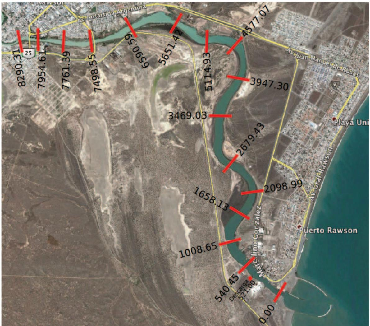
Figura N° 2: Tramo considerado en la modelación, indicando punto de descarga y progresiva de los perfiles transversales.
