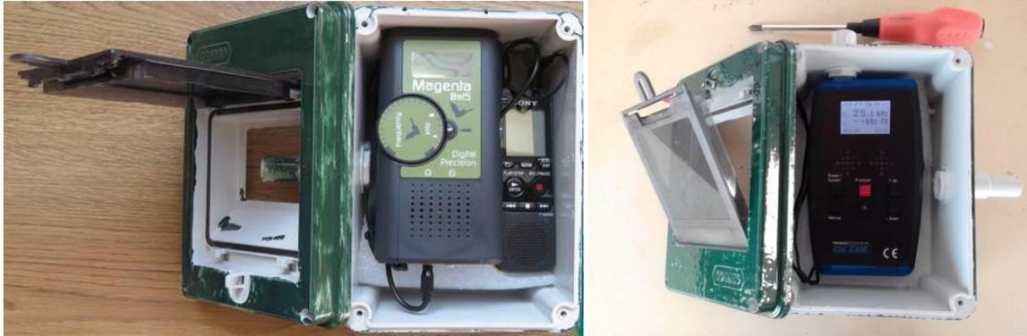
Fotografías 10 y 11. Equipos de ultrasonido detectores de murciélagos utilizados en las estaciones de escucha.
