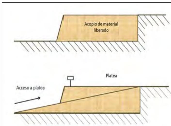
**Figura 3.** Esquema superior: representativo de la metodología de acopio de material liberado en el sector "Este" del Repositorio CP. Esquema inferior: representativo de la distribución del material acopiado, y armado de platea con camino de acceso.
