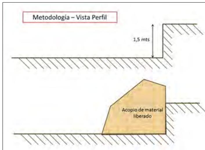
**Figura 2.** Esquema representativo de la metodología de acopio de material liberado en el sector “Este” del Repositorio CP.
