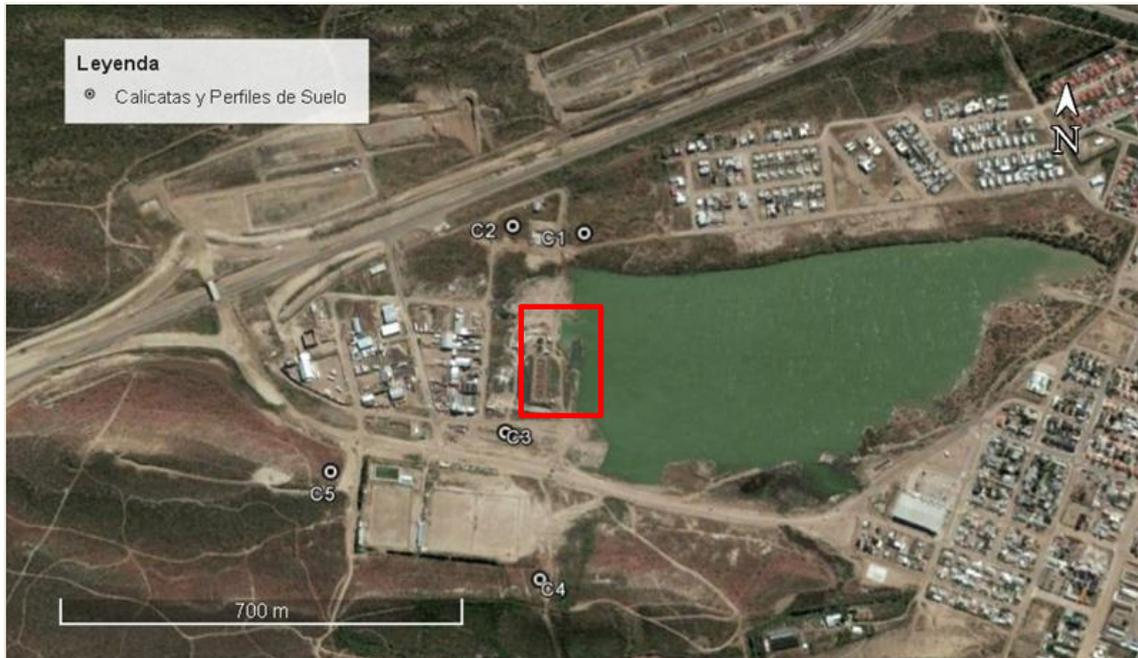
Figura 4: la imagen muestra los sectores en donde se realizaron calicatas y análisis de perfiles de suelo en cortes del terreno en sectores vírgenes en inmediaciones del área de estudio indicada por el polígono rojo. Fuente Google earth.
