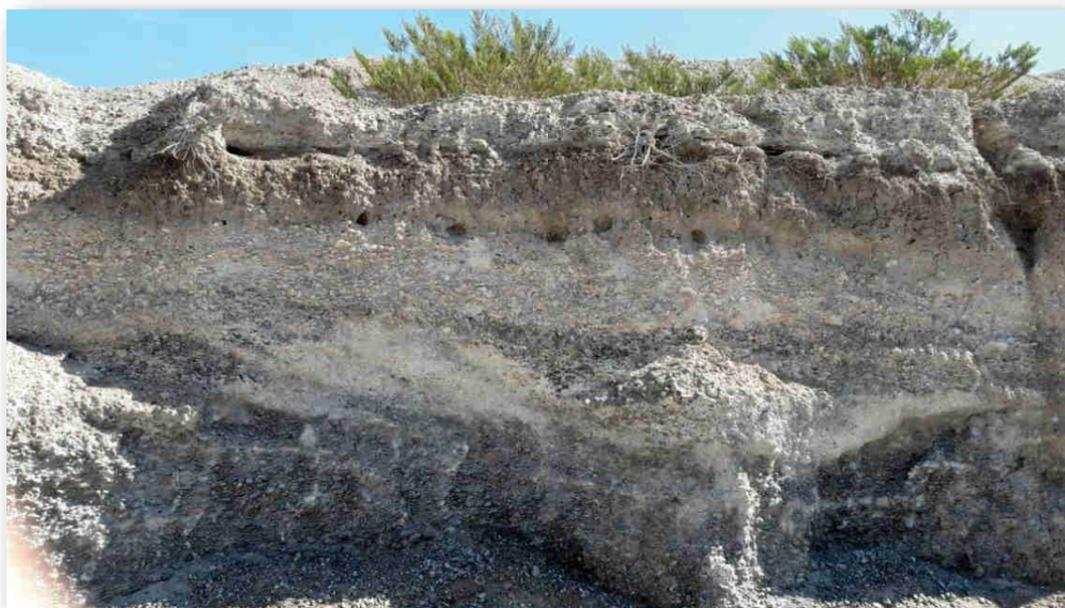
Foto N° 23: Conglomerado poliomíctico con cemento calcáreo. Perfil de una cantera de áridos en el área del proyecto.
