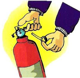
2- Colóquese a una distancia de 3 metros en la dirección del viento y apunte la boquilla del extintor hacia la base de la llama.
