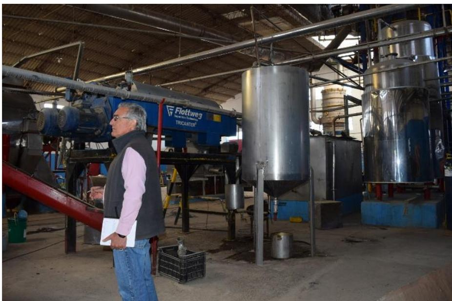
**Foto 10** Los líquidos generados en la cocción y la prensa son procesados a través de una separación por centrifugado y decantación en el equipo que se ve en la imagen (de color azul)
