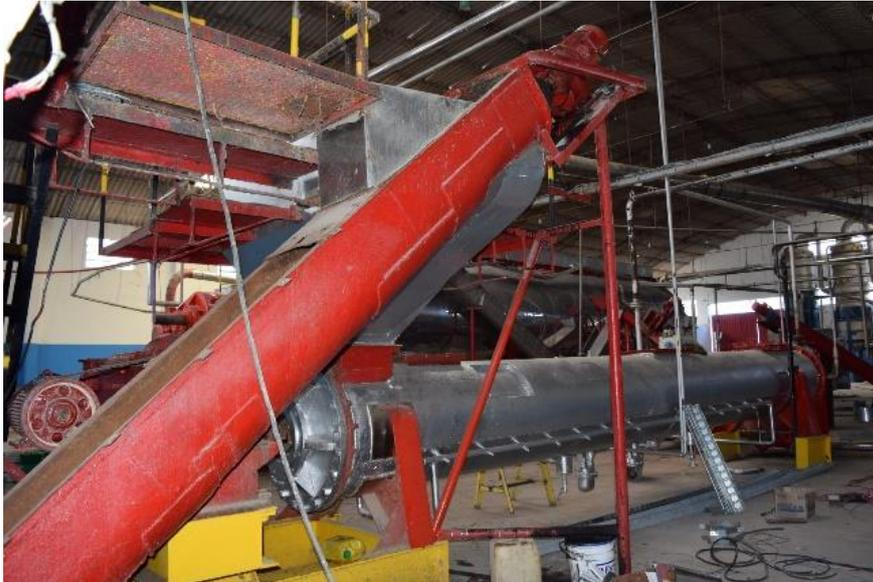
**Foto 7.** Vista del sinfín N° 2 (situado en el interior del galpón de planta), que recibe la carga del sinfín N° 1 y descarga en el equipo "cocinador" (cilíndrico horizontal plateado, derecha de la foto).
