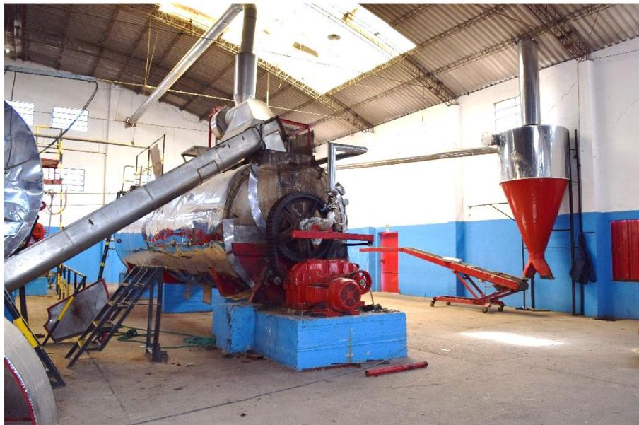
**Foto 20.** Vista del secador 2 con su evacuación de gases superior que acomete contra la pared del fondo del galpón
