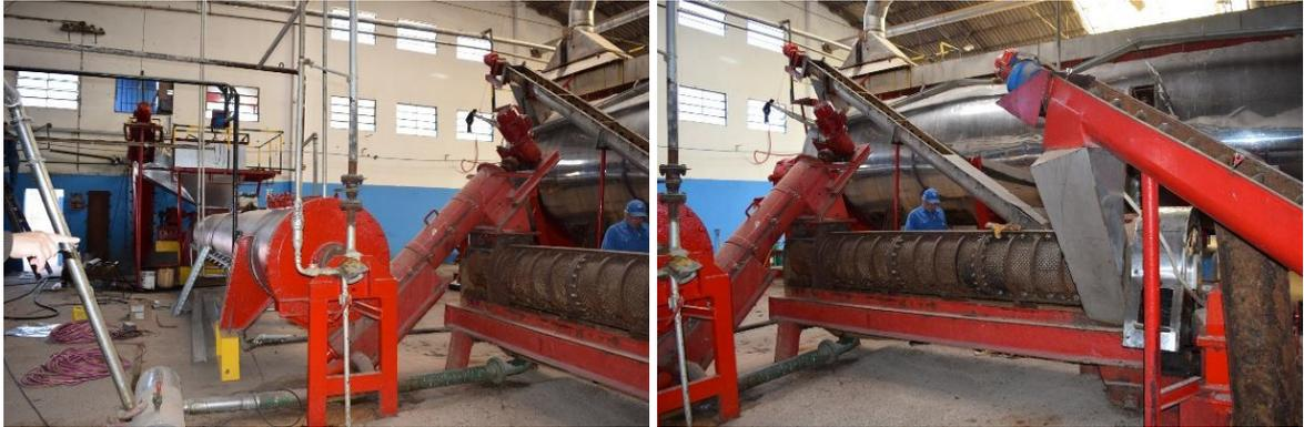
**Foto 8 y 9.** A la izquierda vista, al centro de la imagen, del "cocinador" con elevador de carga a la "prensa" (en el extremo derecho de la misma imagen). La foto de la derecha muestra la "prensa" con su alimentación y descarga en el equipo "secador" N°1
