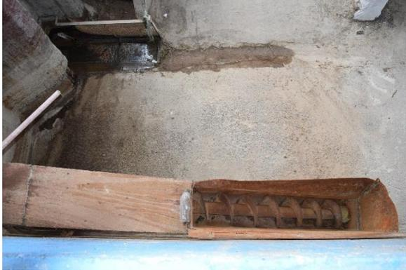
**Foto 5.** La imagen muestra el sinfín N° 1 que se carga con pala tipo bobcat desde el interior de la fosa de recepción de materia prima
