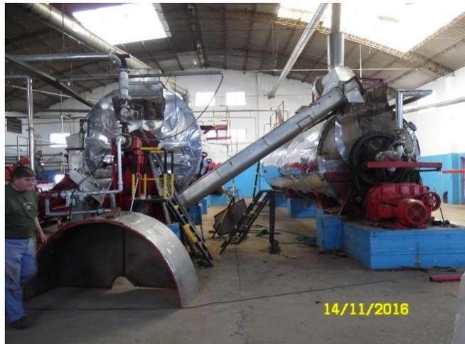
En la imagen de la izquierda (foto 13), se ve el equipo de molienda a emplear (molino de martillos) y la unidad de elevación de la harina producida, hasta el silo de acopio transitorio para su posterior embolsado. A la derecha de la imagen, puede verse parte del secador N°2 anteriormente señalado.
