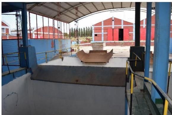
**Foto 3.** Imagen de la tolva para el vuelco de la materia prima en las fosas de recepción
