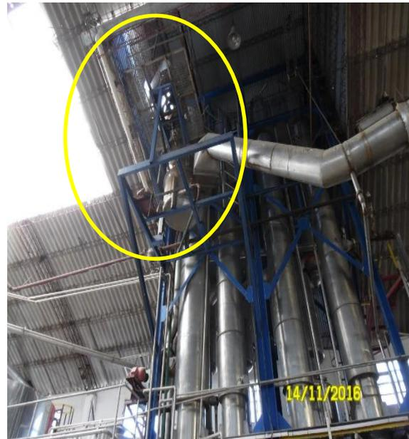
**Foto 15.** Parte superior del evaporador de múltiple efecto y vacío
