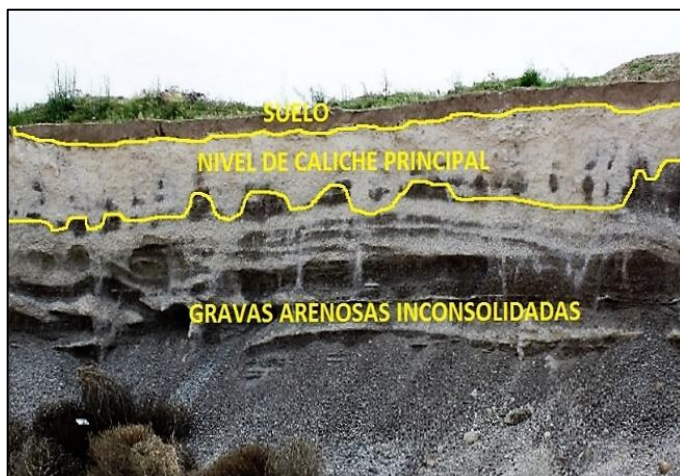
Fotografía 5.1. Perfil litológico en cantera desconocida (punto 2).
