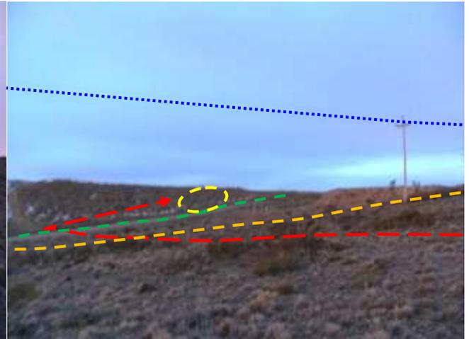
**Foto III.A-32.** Fin de futuro emplazamiento del gasoducto por terreno virgen. Se observan interferencias con línea eléctrica (azul), con camino de acceso al Pozo PVM-891 (naranja) y con camino (verde). Se observa zona de empalme con gasoducto existente de 8" (amarillo). Fotografía en dirección NE (45° 52' 30,13" S - 68° 38' 31,41" O).
