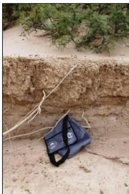
A la izquierda suelos francos, con desarrollo de horizontes areno-limosos. A la derecha suelo con estructura, en la base horizonte A11 areno franco- gravilla fina, con horizonte B2t arcillo limoso en superficie, cubierto por arena. Abajo izquierda suelo muy poco desarrollado, horizonte A11 sin estructura, arenoso con gravas medianas a gruesas, escasas raíces. A la derecha potente suelo de acumulación
