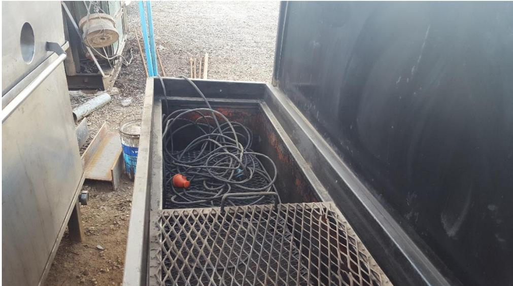
Figura 17: Vista interior de la cuba con la reja de escurrimiento y el sistema eléctrico de la resistencia.
