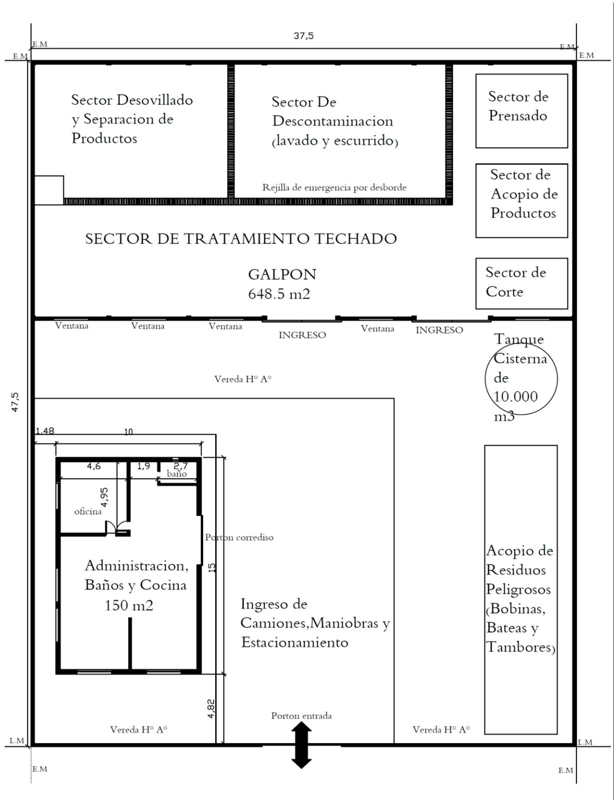
Figura 10: Plano de las instalaciones existentes y a incorporar
