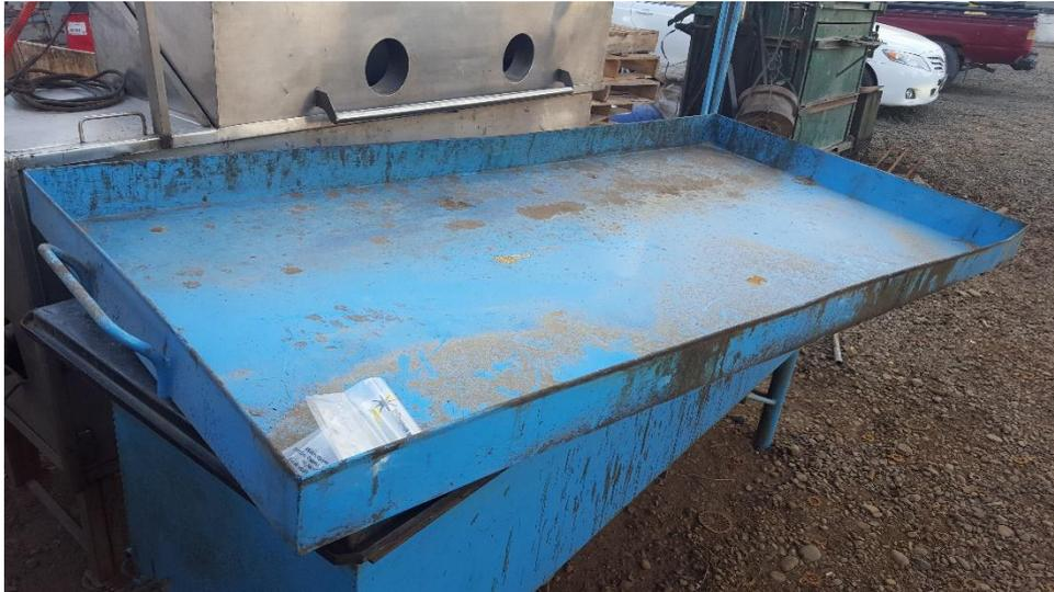
Figura 16: Bandeja metálica que se colocará contra el piso de cemento para evitar cualquier tipo de goteo.
