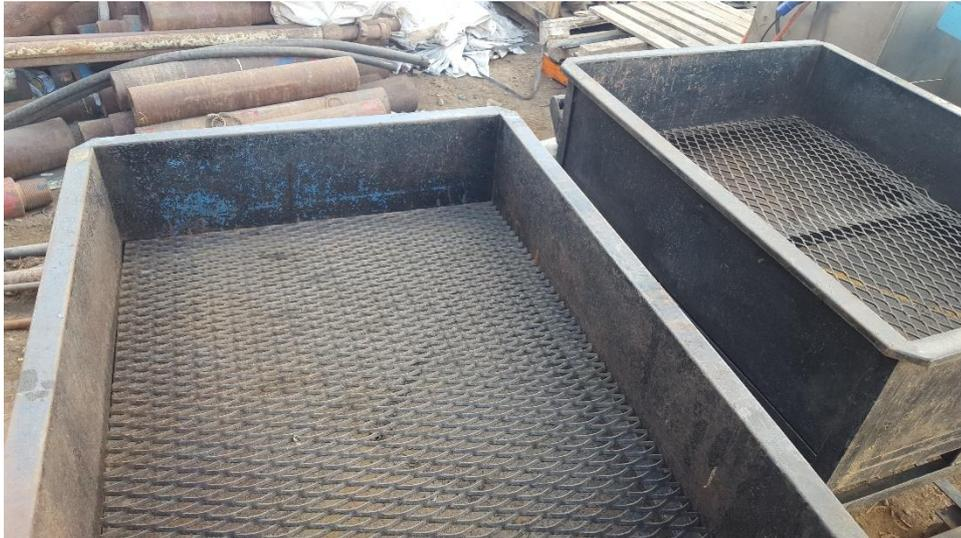
Figura 18: Vista interior de las cubas de escurrimientos a utilizar.
