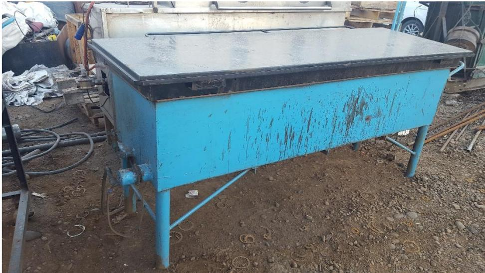
Figura 15: Cuba para la limpieza de los cables cortados de un metro de longitud.
