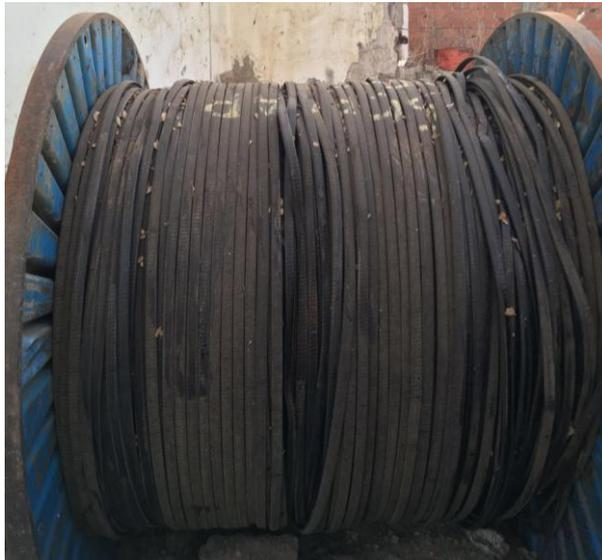
Figura 12: Bobina de cable en desuso contaminado con hidrocarburo
