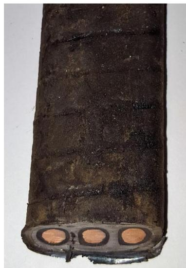
Figura 14: Sección del cable a tratar en el proceso
