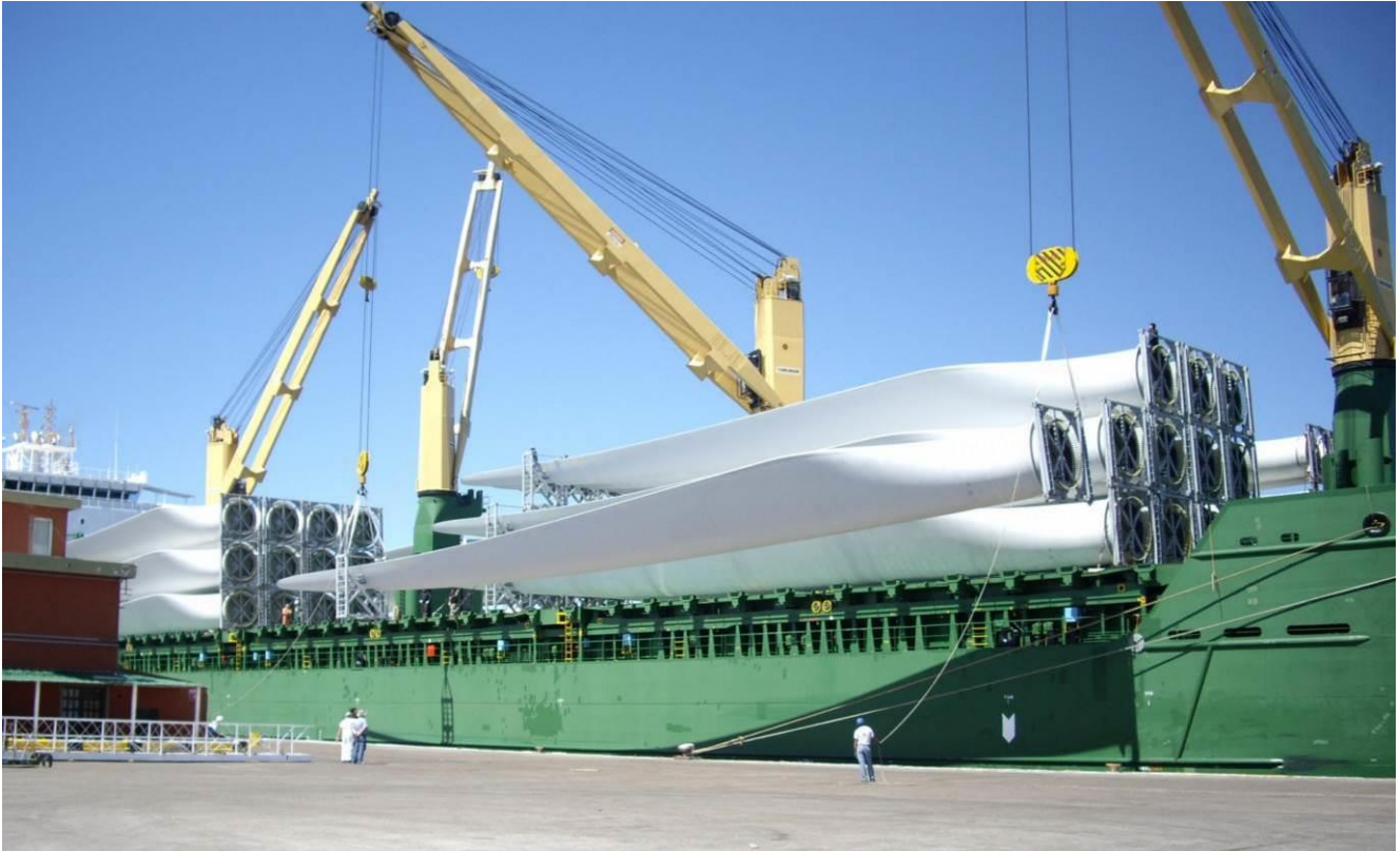
Figura 111. Arribo y descenso de palas de aerogeneradores del PE Loma blanca IV en muelle Almirante Storni.
