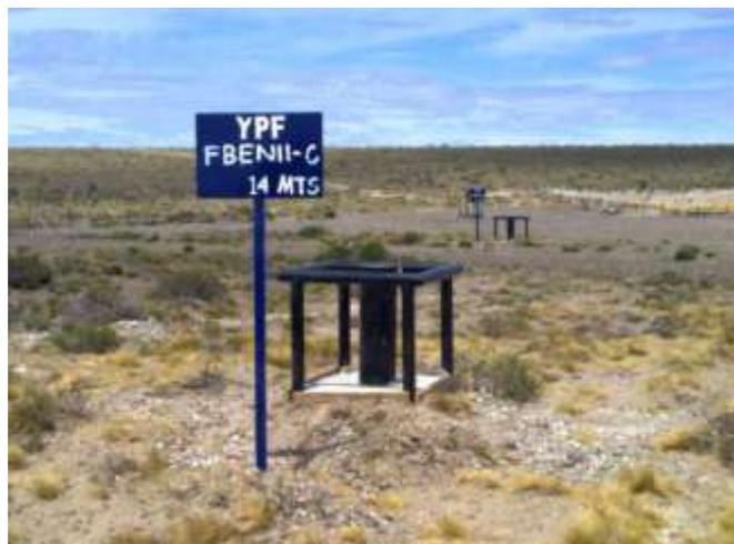
**Foto IV.1-6.** Freático FBENII-C, ubicado 80 metros al Noreste de la zona de tanques de la batería, fuera de su predio.
