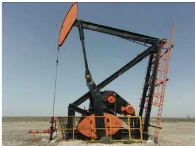
**Foto III.B-31.** Vista del equipo de extracción AIB (Aparato individual de bombeo) del Pozo EN-627. Foto en dirección S.
