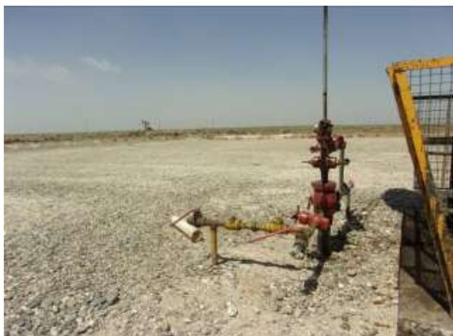
**Foto III.B-13.** Vista del puente de producción del Pozo EN-625. Foto en dirección S.
