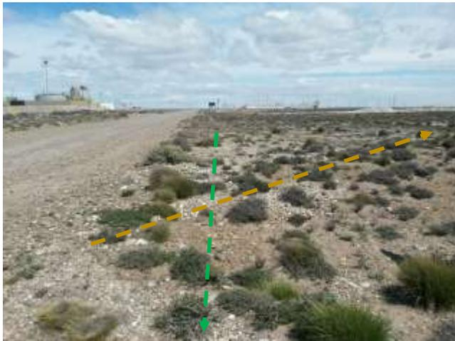
**Foto III.B-3.** Emplazamiento de acueducto por margen interno de camino (verde) e interferencia con picada existente. Foto en dirección E.
