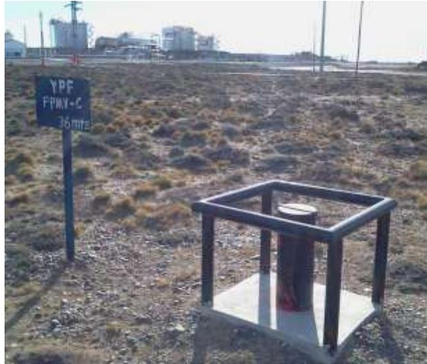
**Foto IV.1-9.** Freatímetro FPMV-C, ubicado 150 m al Sureste de la planta, fuera de su predio.
