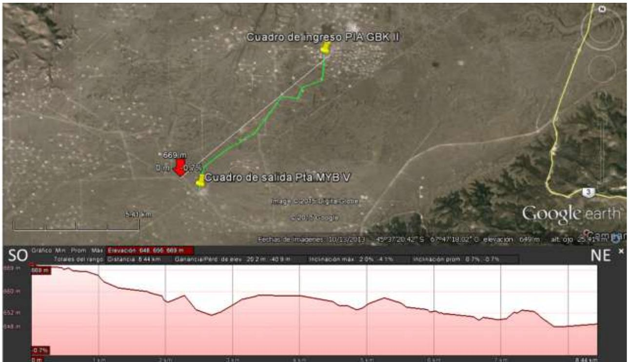
Figura IV.1-8. Perfil topográfico SO-NE paralelo a la traza del ducto.
