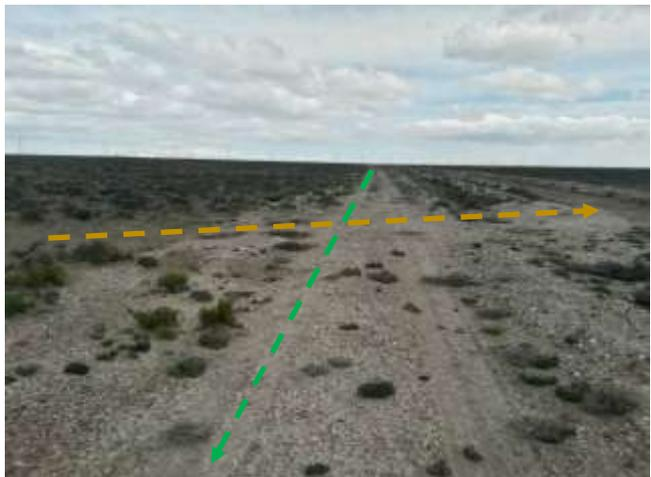
**Foto III.B-12.** Emplazamiento de acueducto por picada existente (verde). Interfiere picada (marrón). Foto en dirección E.
