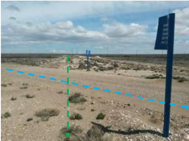
**Foto III.B-15.** Emplazamiento de acueducto por picada existente (verde). Interfiere camino de acceso (celeste). Foto en dirección SO.
