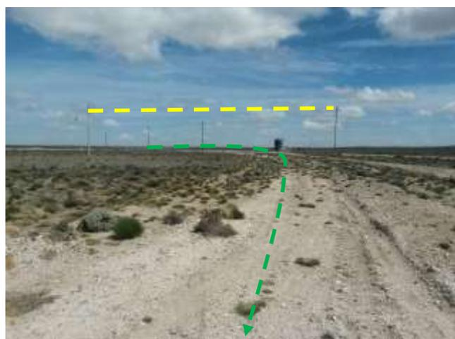
**Foto III.B-25.** Emplazamiento de acueducto por picada existente (verde). Interfiere línea eléctrica (amarillo). Foto en dirección SO.
