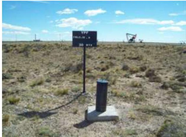
Foto IV.1-4. Freatímetro FBLCIII-A, con cartel de identificación correspondiente.
