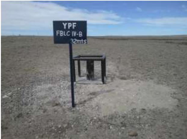
Foto IV.1-7. Freatímetro FBLCIV-B, ubicado en el extremo Sureste a 35 m de la batería.
