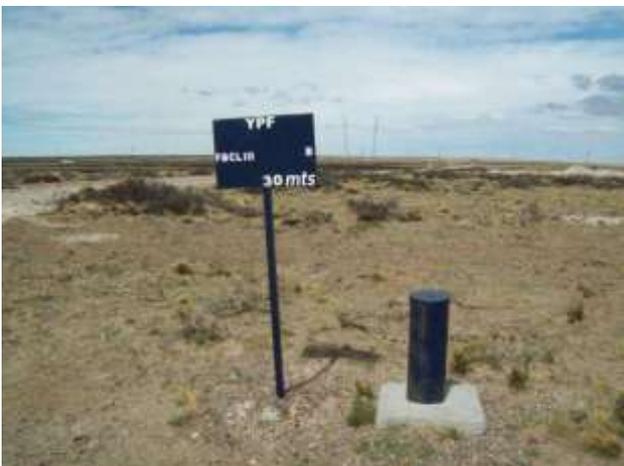
Foto IV.1-5. Freatímetro FBLCIII-A, con cartel de identificación correspondiente.
