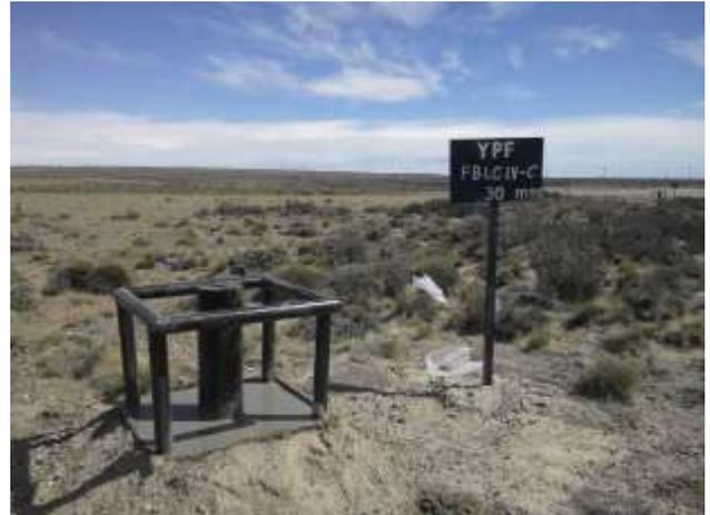
Foto IV.1-8. Freatímetro FBLCIV-C, ubicado 10 m al Norte de la batería.
