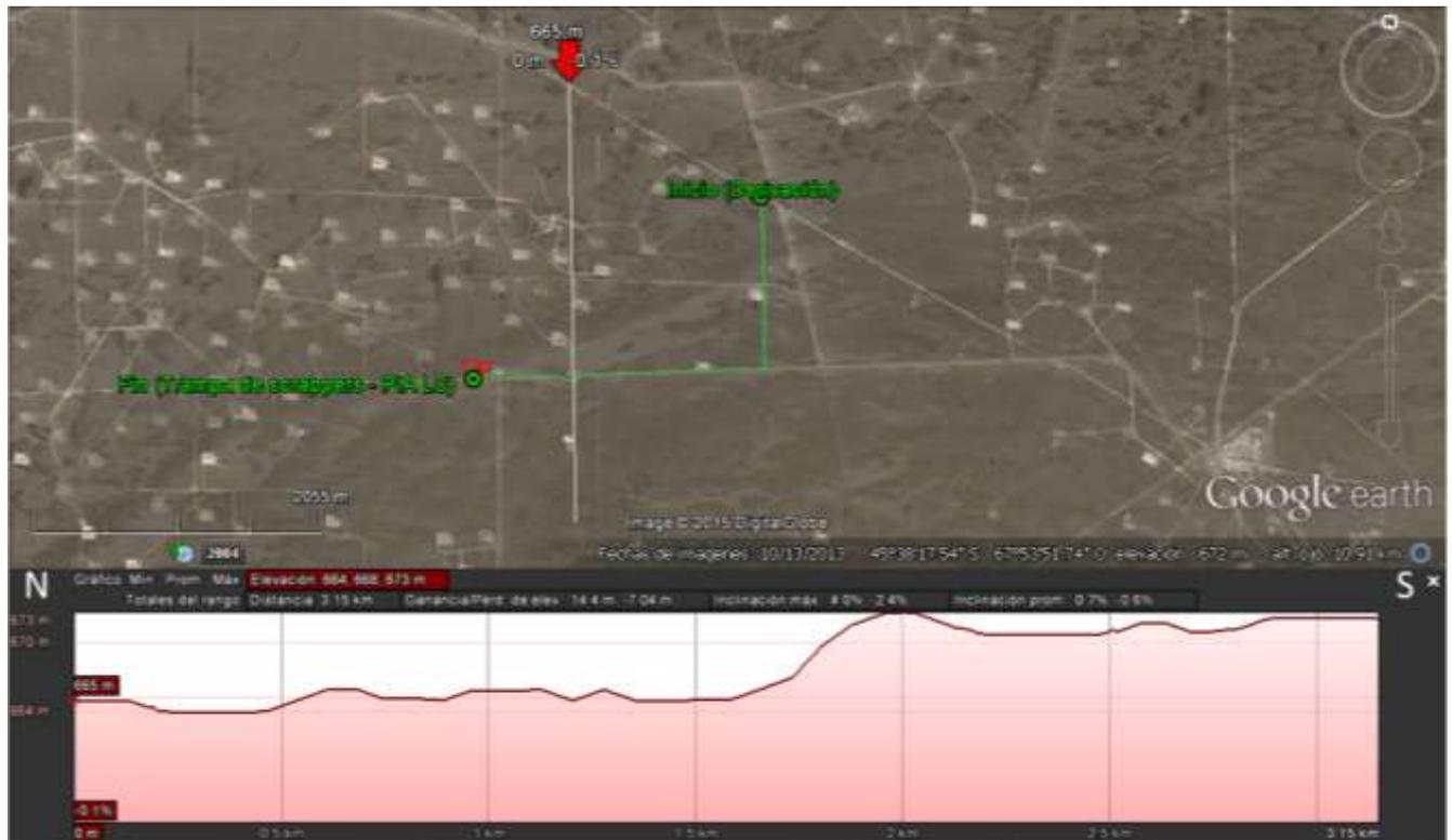
**Figura IV.1-8.** Perfil topográfico en sentido Sur - Norte en el área del Proyecto, inclinando suavemente hacia el Norte (Se indica con una flecha roja el inicio del perfil topográfico y en verde el trazado del futuro acueducto).
