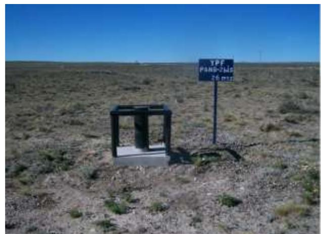
Foto IV.1-8. Freáímetro FRMB-2bis, ubicado 20 metros al sur del cerco perimetral de la instalación, fuera de su predio.
