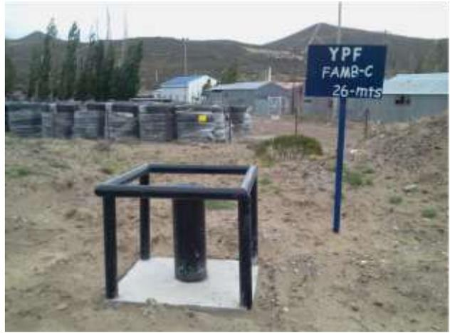
**Foto IV.1-12.** Freatímetro FAMB-C, ubicado en el sureste de la locación, fuera del predio.
