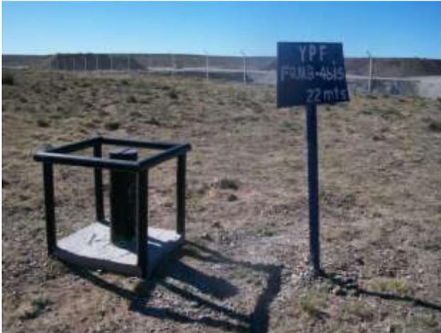
**Foto IV.1-9.** Freatímetro FRMB-4bis, ubicado 17 metros al norte del cerco perimetral de la instalación, fuera de su predio.
