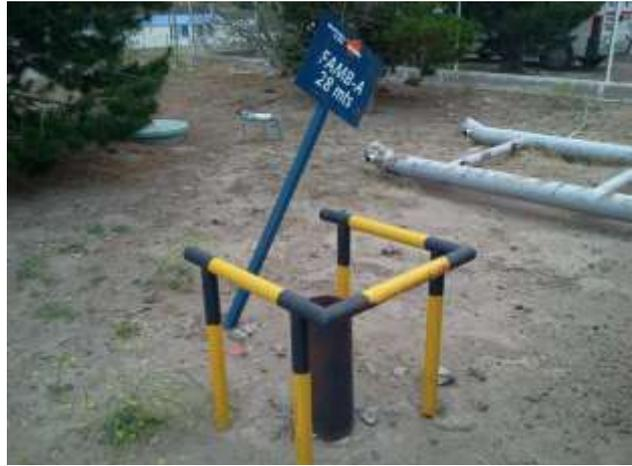
**Foto IV.1-10.** Freatímetro FAMB-A, ubicado dentro del predio.
