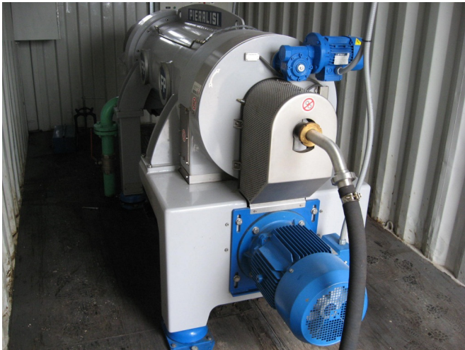
Figura 15: Centrifuga decanter Piralisi
