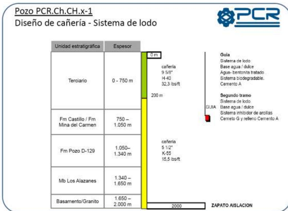
Figura 01. Esquema de técnico y estratigráfico del pozo
