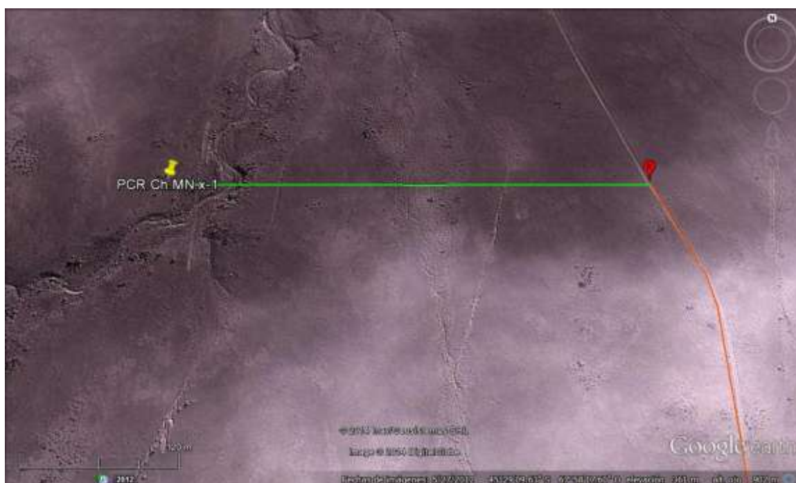
Imagen 05. Vista de punto 8 y acceso a pozo (en verde picada de acceso a construir)
