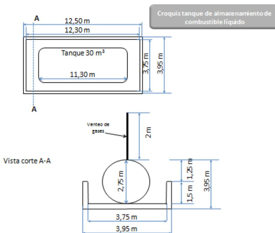
**Figura 02. Tanque de almacenamiento de combustible líquido.**
