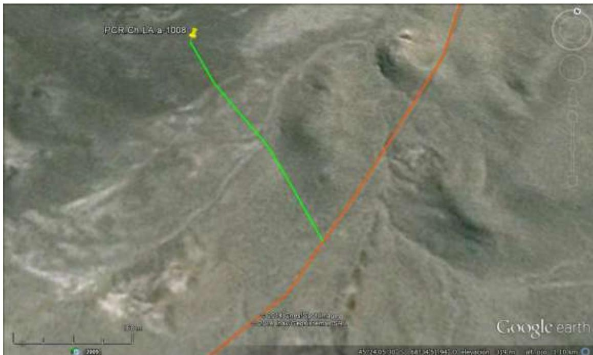
**Imagen 03. Vista acceso a construir al pozo desde picada existente (traza de color verde).**
