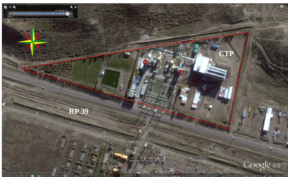
Figura 3.1.1 – Imagen satelital de la CTP. En línea roja se muestra el límite del predio, y en círculos rojos las chimeneas de los equipos generadores existentes.
