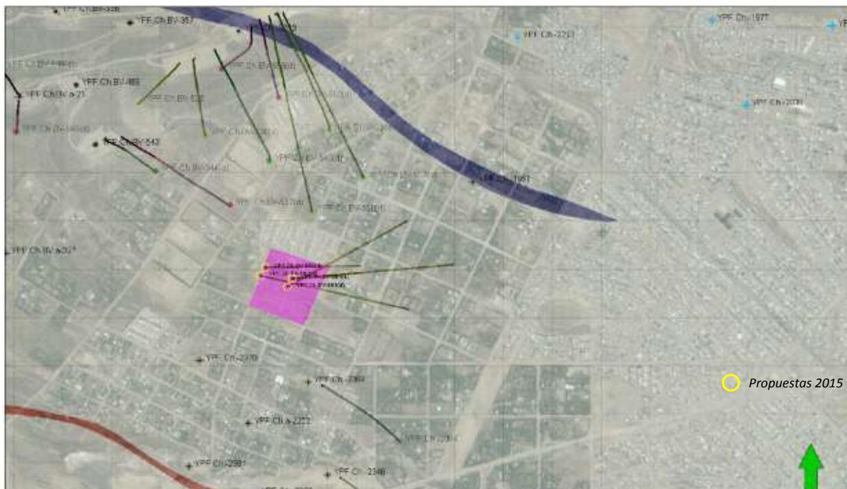
**Figura VIII.3-1.** Extensión del bloque “Bella Vista Sur” con los 26 pozos perforados a la fecha, y las propuestas 2015 a perforar. Pueden observarse los límites de esta estructura, la falla azul (con buzamiento Sur) y la falla roja (con buzamiento Norte).
