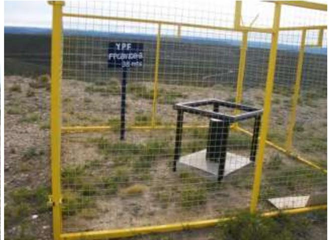
**Foto IV.1-10.** Freatímetro FPCBV108-B, ubicado a 15 m al Norte del cerco perimetral de la Planta.
