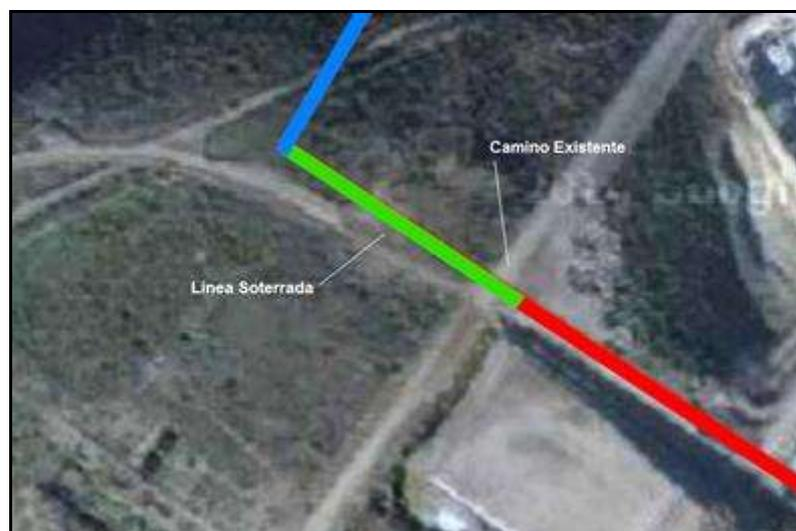
Figura III.B-6. Trazo de LET soterrada en intersección con futuro camino de Circunvalación.
