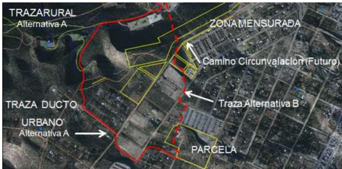
Figura III.A-3. Alternativas de ubicación para la traza de los ductos
