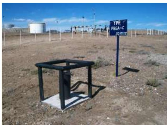
Foto IV.1-18. Freatímetro FBEA-C, ubicado al NO de la zona de tanques de la Batería EA.
