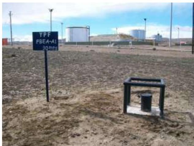
Foto IV.1-16. Freatímetro FBEA-A1, ubicado al NO de la pileta de emergencias de la Batería EA.
