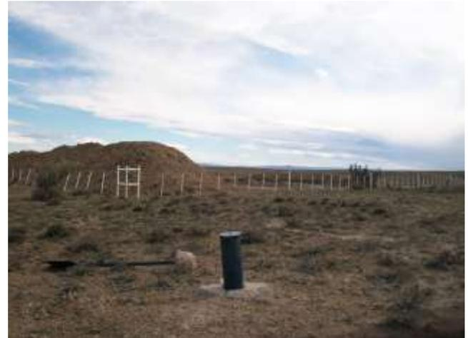
**Foto IV.1-12.** Freatímetro FCEA31-B, ubicado al sureste de la cantera.
