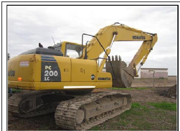
Foto N°: IV.1.2.l: Retroexcavadora Komatsu
