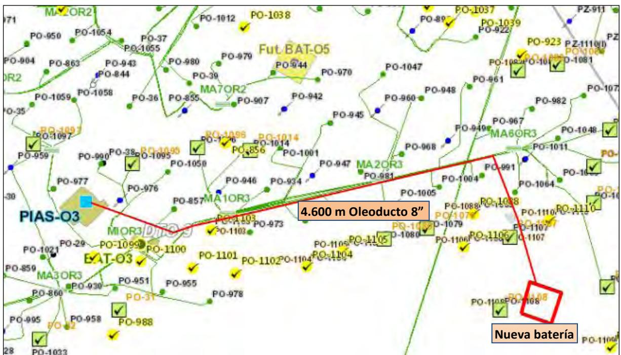
**Figura 7.1** Oleoducto de salida de la futura batería hacia la PIAS O3.
