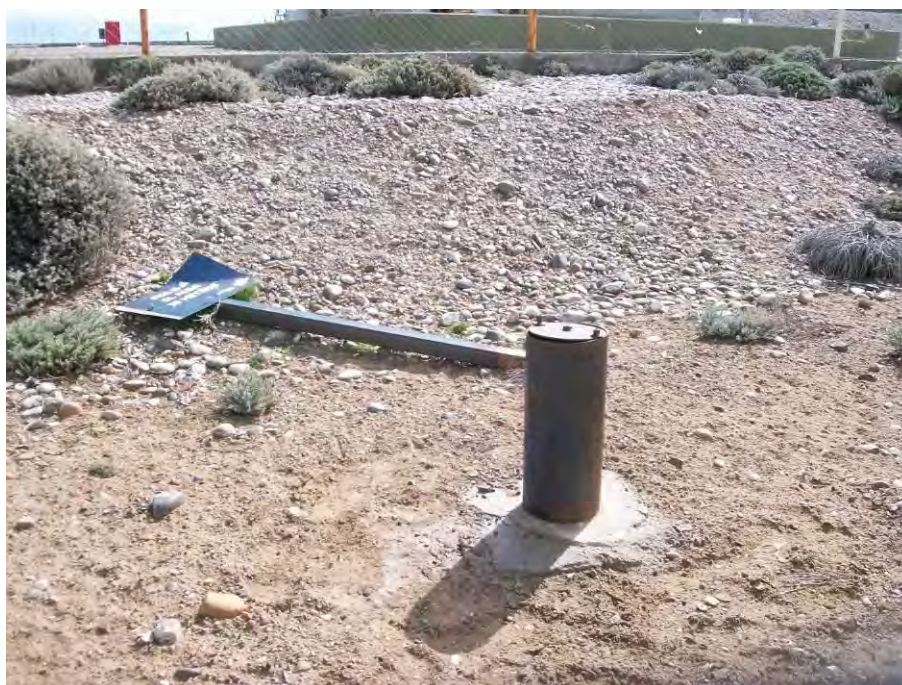
FOTO 1: Freatímetro FBEAII-A, el mismo se ubica fuera del predio de labatería. El cartel identificador se encuentra dispuesto sobre el suelo.
