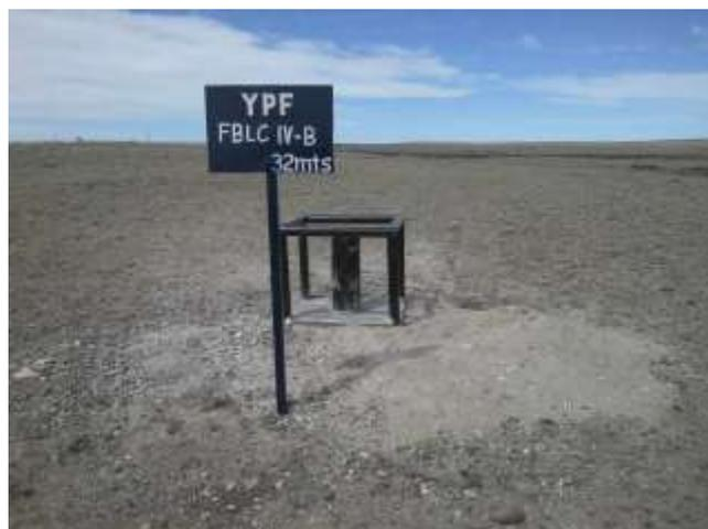
**Foto IV.1-10.** Freatímetro FBLCIV-B, ubicado en el extremo sureste a 35 m de la batería, fuera del predio.
