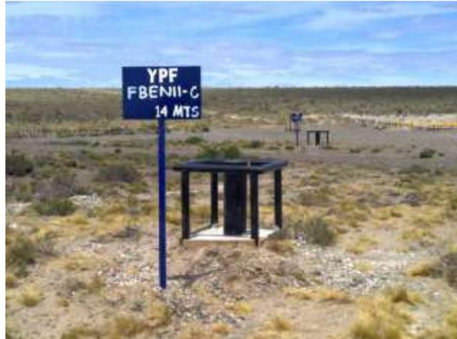
**Foto IV.1-8.** Freatímetro FBENII-C, ubicado 80 m al Noreste de la zona de tanques de la batería, fuera de su predio.
