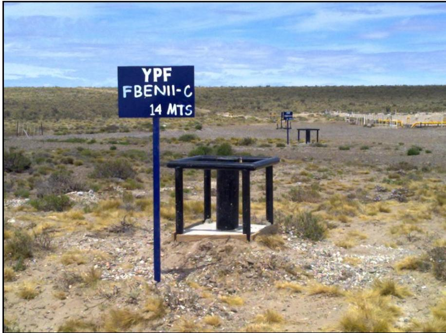
*FOTO 3: Freatímetro FBENII-C, ubicado 80 metros al noreste de la zona de tanques de la batería, fuera de su predio.*
