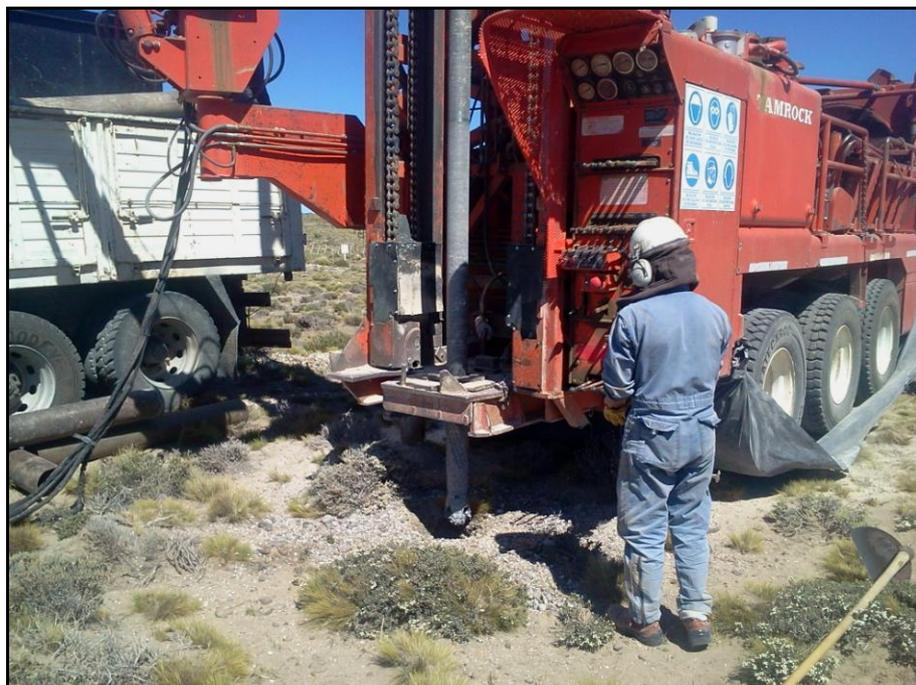
*FOTO 4: Máquina Perforadora DRILLTECH D- 40 KK. Como se puede observar en la fotografía, la broca empleada en la perforación es un tricono de 6 1/2 pulgadas de diámetro.*
