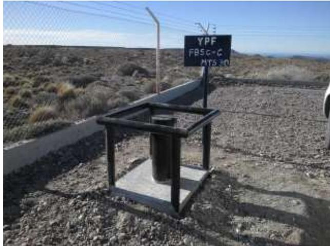
**Foto IV1-11.** Freatímetro FBSC-C, ubicado a aproximadamente 13 metros al Noreste de la pileta de emergencias de la instalación, dentro del predio de la Batería.
