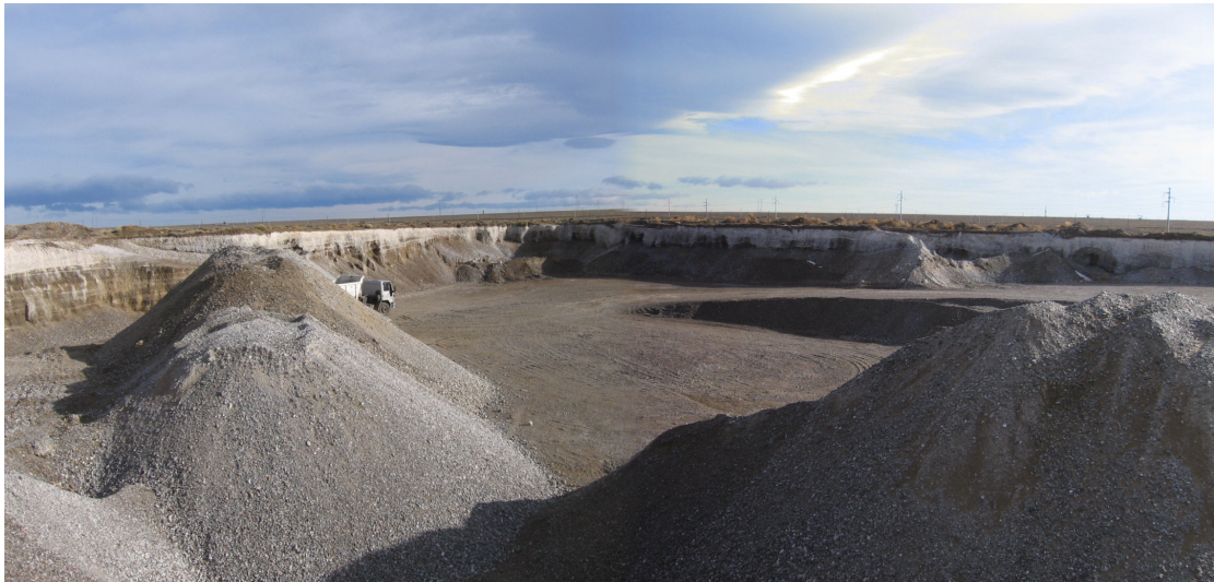
Figura 27. Vista panorámica de la cantera; plataforma de trabajo y frente de explotación
