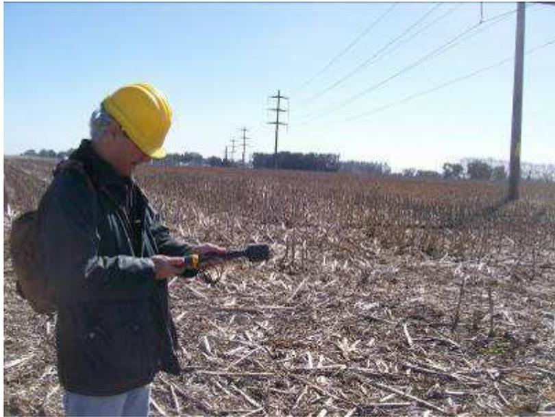
**Fig. 2. Medición de Campo Magnético.**
