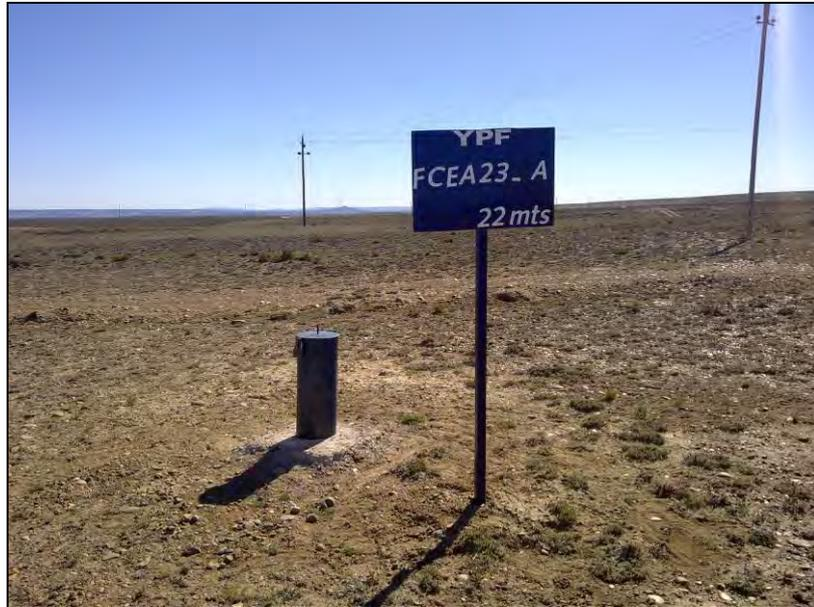
*FOTO 1: Freatímetro FCEA23-A, ubicado al oeste de la futura cantera.*
