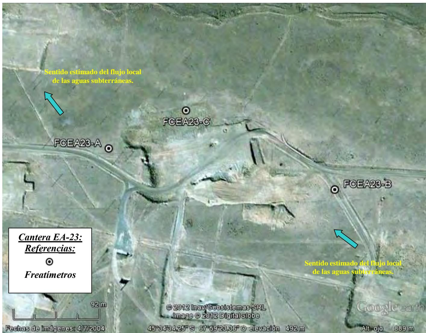
*Imagen Satelital tomada del Google Earth, donde se puede observar la ubicación relativa de los freatímetros pertenecientes a dicha instalación, y el sentido estimado de flujo local de aguas subterráneas en la zona de estudio.*
