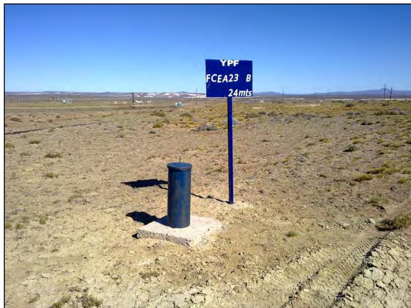
*FOTO 2: Freatímetro FCEA23-B, ubicado al este de la futura instalación.*
