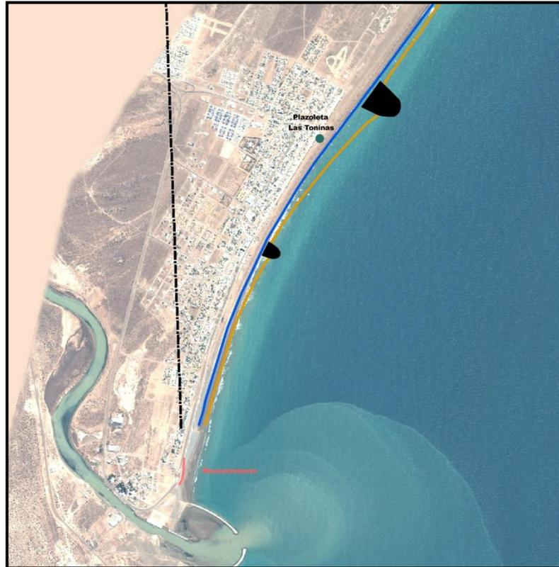
Figura 3.6 Vista de la Alternativa 2. En Rojo Revestimiento, en Amarillo la Línea de Costa después de Refulado y en Negro las Estructuras Propuestas
