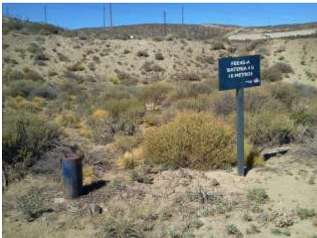
**Foto IV.1-4.** Freatímetro FBE4G-A, ubicado aguas abajo de la pileta de emergencias de la instalación.
