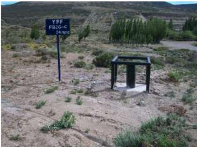
**Foto IV.1-10.** Freatímetro FB2G-C, ubicado al Noreste de la zona de tanques de la batería.
