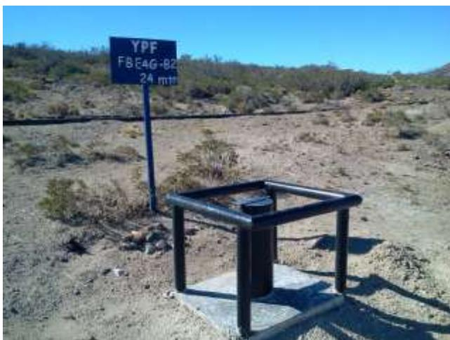
**Foto IV.1-6.** Freatímetro FBE4G-B2, ubicado 100 m al Sureste del cerco perimetral de la batería.
