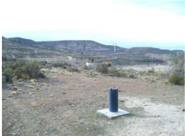
**Foto IV.1-9.** Freatímetro FB2G-B, ubicado al Suroeste de la batería.
