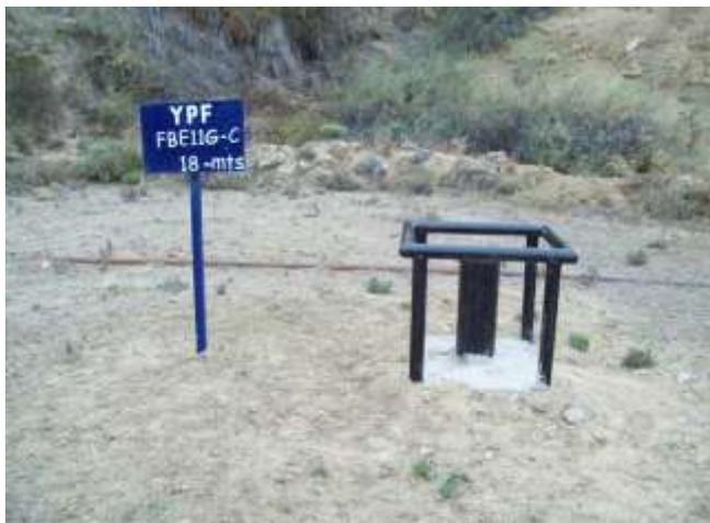
**Foto IV.1-13.** Freatímetro FB11G-C, situado aguas arriba de la batería.
