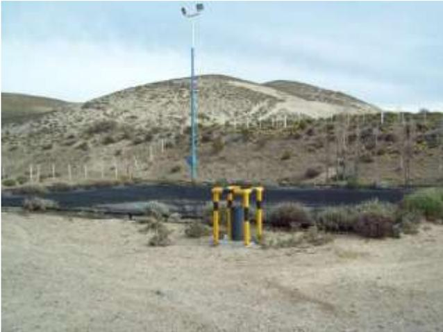
**Foto IV.1-8.** Freatímetro FB2G-A, ubicado al Noreste de la pileta de emergencias de la instalación, dentro de su predio.
