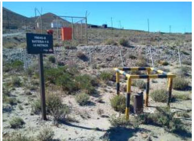
**Foto IV.1-5.** Freatímetro FBE4G-B, ubicado aguas abajo de la instalación.
