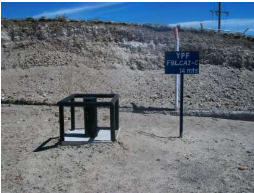
Foto IV.1-8. Freatímetro FBLCAI-C, ubicado a 45 m al Noroeste de la zona de tanques de la Batería, dentro del predio de la misma.
