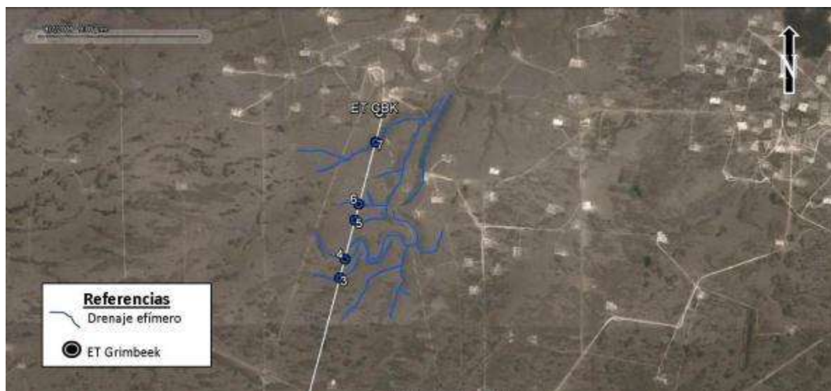
Figura VI.1-13. Drenajes que interfieren con la traza de la Línea en el área de Grimbeek al Noreste del Proyecto.
