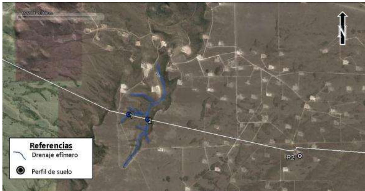
Figura IV.1-12. Drenajes que interfieren con la traza de la Línea en el sector de El Alba.
