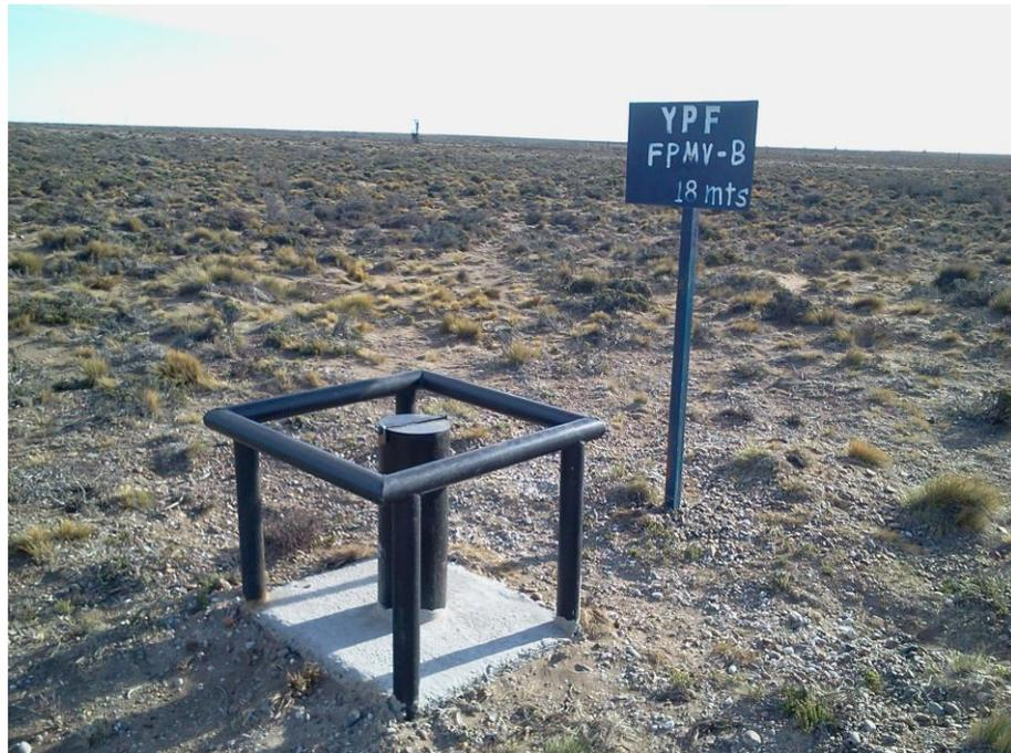
*FOTO 3: Freatímetro FPMV-B, ubicado 100 metros al noroeste de la ampliación de la planta, fuera de su predio.*
