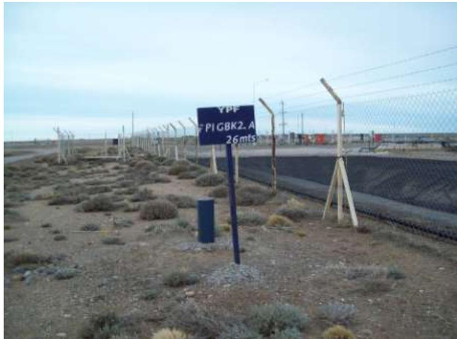
*FOTO 1. Freatímetro FPIGBK2-A. El mismo se ubica al Norte de la Pileta de emergencias de la Batería Grimbeek 2.*
