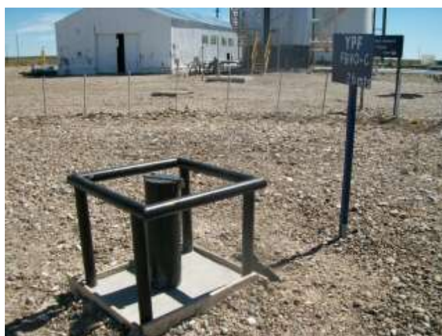
Foto IV.1-4. Freatímetro FBVO-C, ubicado 50 m al Sureste de la zona de tanques de la Batería, fuera del predio de la batería.
