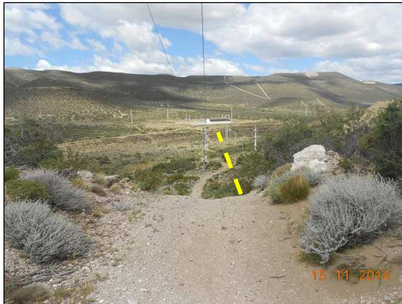
Imagen III.A.11. Punto de quiebre del acueducto, donde finalizará la línea punteada anterior y retomará con dirección SO-E. Las tuberías se colocarán, en la mayor parte del recorrido, sobre un antiguo camino preexistente.
