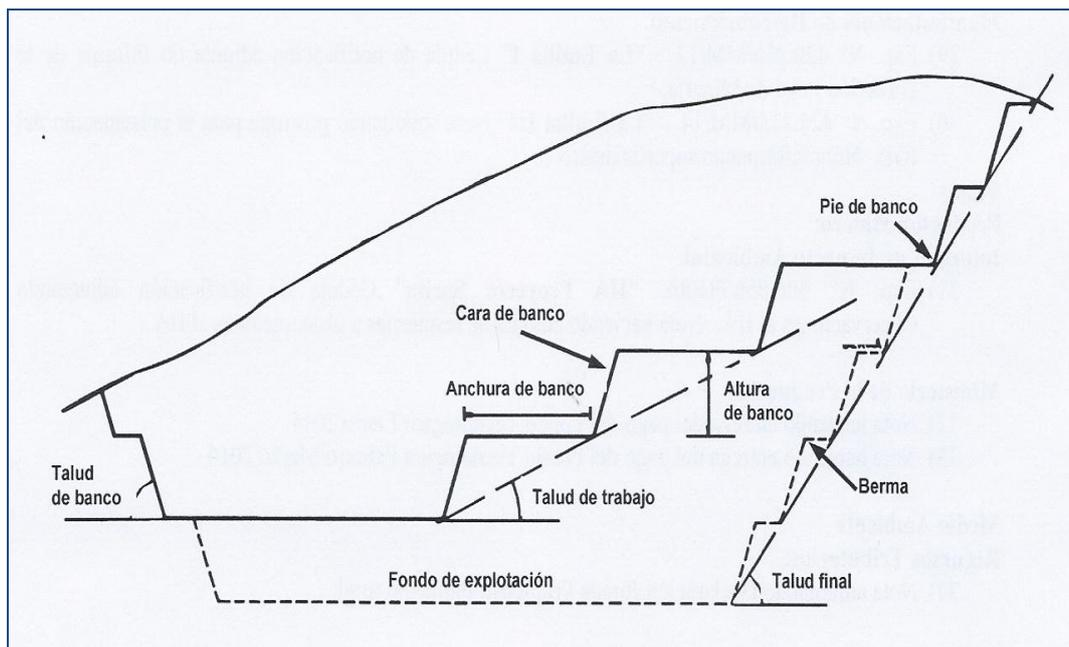
**Figura 7: Corte general de una cantera. (Fuente: CIMSA)**
