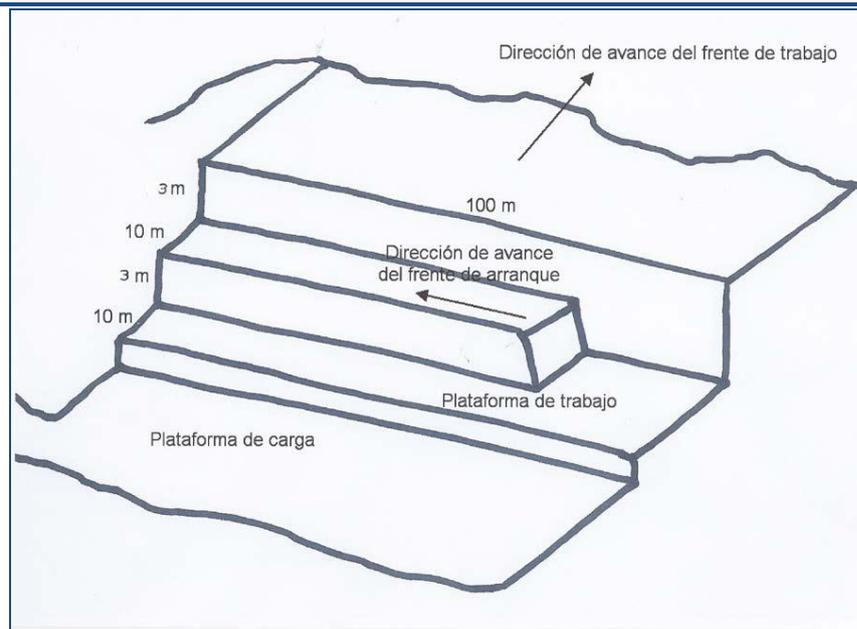
Figura 8: Corte general de una cantera. (Fuente: CIMSA)
